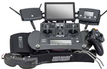
▼ Mobile Bodenstation, Videobrille, High-Quality-Vorschaumonitor, unabhängige Kamerasteuerung.
